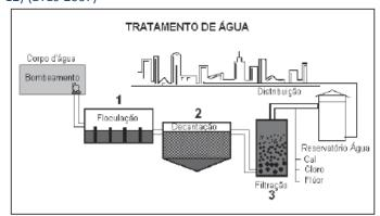
Após o processo de clarificação, a água ainda não está pronta para ser usada. Para garantir a qualidade da água, é feita a cloração, acerto de pH e a fluoretação. Esses processos têm como objetivos, respectivamente, a) desinfetar, melhorar o sabor e neutralizar a acidez da água.
