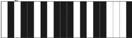
Se o leitor óptico for passado da esquerda para a direita irá ler: 01011010111010110001
