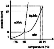
Um método de produção de gelo seco (CO<sub>2</sub> sólido) envolve I – compressão isotérmica do CO2 (g), inicialmente a 25 °C e 1 atm, até passar para o estado líquido;
