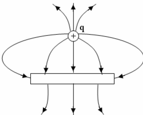
O campo elétrico nas vizinhanças da carga puntiforme e da barra está representado pelas linhas de campo mostradas na figura. Sobre o módulo da carga da barra  $|Q_{bar}|$ , comparativamente ao módulo da carga puntiforme positiva  $|q|$ , e sobre a carga líquida da barra  $Q_{bar}$ , respectivamente, pode-se concluir que:
