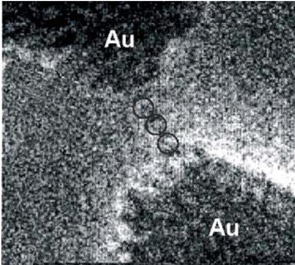
O tamanho dos componentes eletrônicos vem diminuindo de forma impressionante. Hoje podemos imaginar componentes formados por apenas alguns átomos. Seria esta a última fronteira? A imagem a seguir mostra dois pedaços microscópicos de ouro (manchas escuras) conectados por um fio formado somente por três átomos de ouro.
