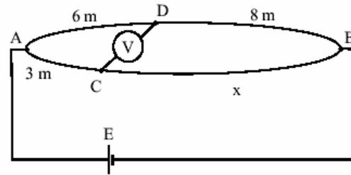
Quando nos pontos **A** e **B** do circuito é ligado um gerador, a diferença de potencial entre os pontos **C** e **D**, lida pelo voltímetro, é zero. Se o fio **x** tem o dobro da área de secção transversal dos outros 3, seu comprimento é, em m, igual a
