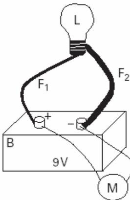
Nestas condições a lâmpada está acesa, tem resistência **R<sub>L</sub> = 2,0Ω** e dissipa uma potência igual a **8,0W**. A força eletromotriz da bateria é **ε = 9,0V** e a resistência do fio **F<sub>1</sub>** é **R<sub>1</sub> = 1,8Ω**. Determine o valor da
