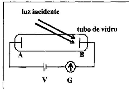
Podemos variar a intensidade e a frequência da luz incidente na placa **B**. No início da experiência, usando luz de baixa frequência, a corrente no amperímetro é nula. Nesse caso, podemos afirmar que:
